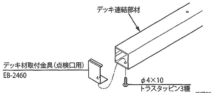
②デッキ材取付金具（点検口用）に、点検口蓋用のデッキ材のツメを差込み、ビスを締込んでください。
