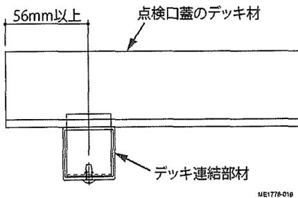
③デッキ材固定金具の固定側で、デッキ材のツメを固定し、ビスでデッキ連結部材に取付けてください。
