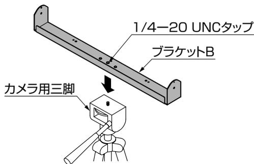
① カメラ用三脚のネジ山にブラケットBを取付けてください。
