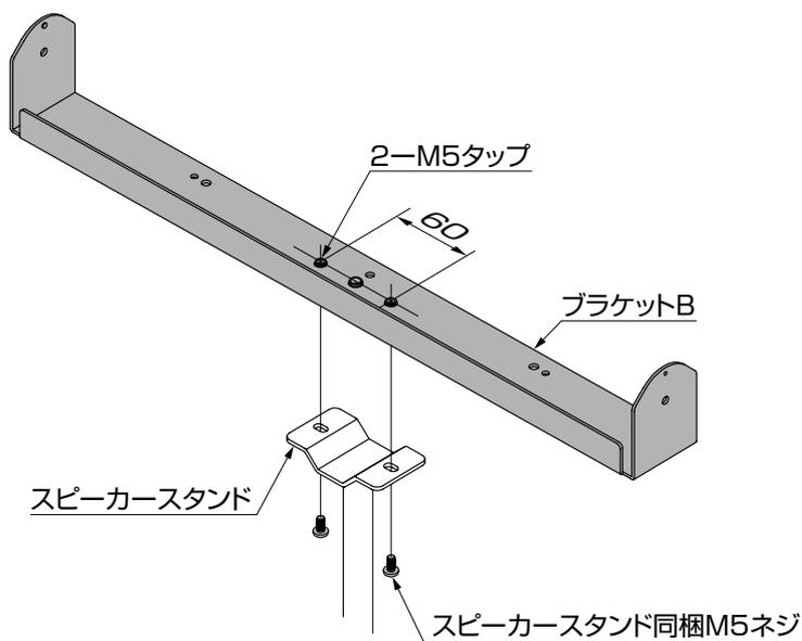
① スピーカースタンドに同梱されているM5ネジでブラケットBに取付けてください。
