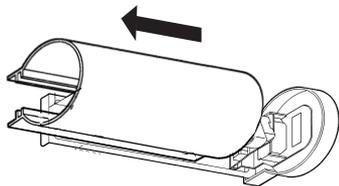
**4** 本体に合わせてカバーを取付け、ツマミネジで
