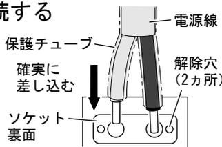
器具の取り替え等で電源線を外す場合は、マイナスドライバー等を解除穴に差し込みながら電源線を引き抜く。
