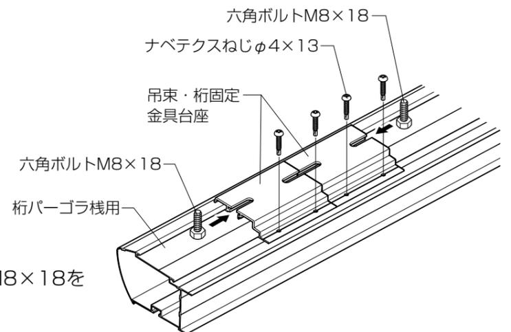
③吊束・桁固定金具台座の長穴に六角ボルトM8×18を差込んでください。
