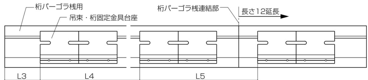
●長さ12延長仕様 吊束・桁固定金具台座取付け寸法
