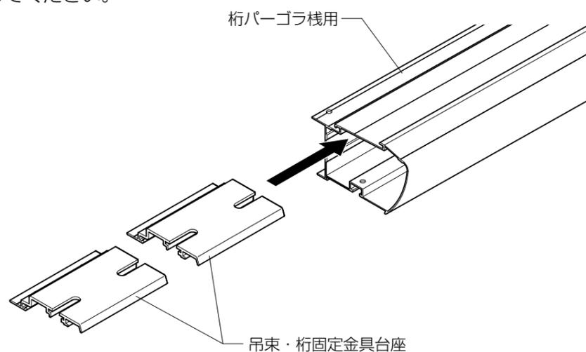
②桁パーゴラ棧用に吊束・桁固定金具台座をナベテクスねじφ4×13で取付けてください。
