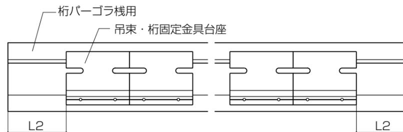
●標準(延長なし)仕様 吊束・桁固定金具台座取付け寸法
