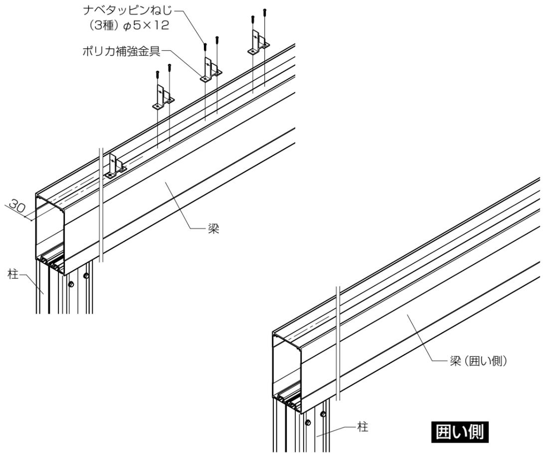
②ポリカ補強金具にポリカ補強材を取付けてください。
