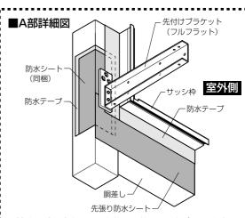
※外壁の透湿防水シートを後から施工する場合は、左右・ 下ともに100~150mm程度の重ねができるように してください。
