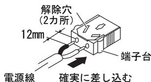
器具の取り替えなどで電源線を外す場合は、マイナスドライバーなどを解除穴に差し込みながら電源線を引き抜く。
