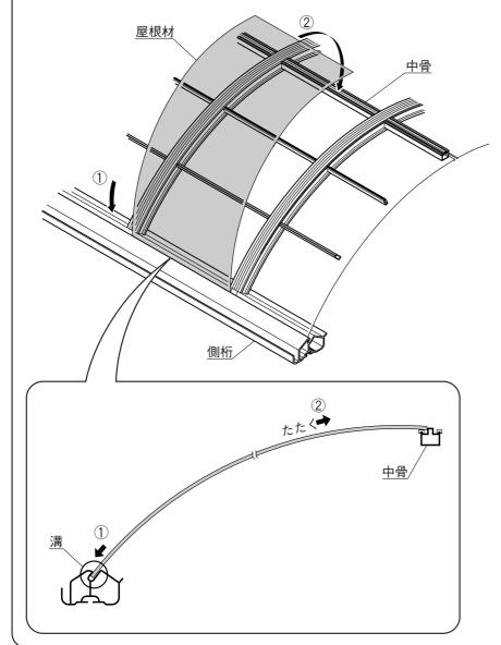
■側桁の溝に屋根材を入れ、取付けてください。この時、屋根材を中骨の方にたたきながら延ばすようにすると、取付けが楽になります。
