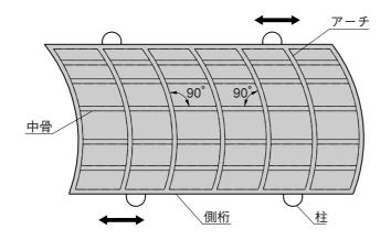
■アーチと中骨が直角かどうか調べ直角が出ていない場合は、桁を固定しているボルトを軽くゆるめ、アーチと中骨が直角になるように側桁を移動してください。
