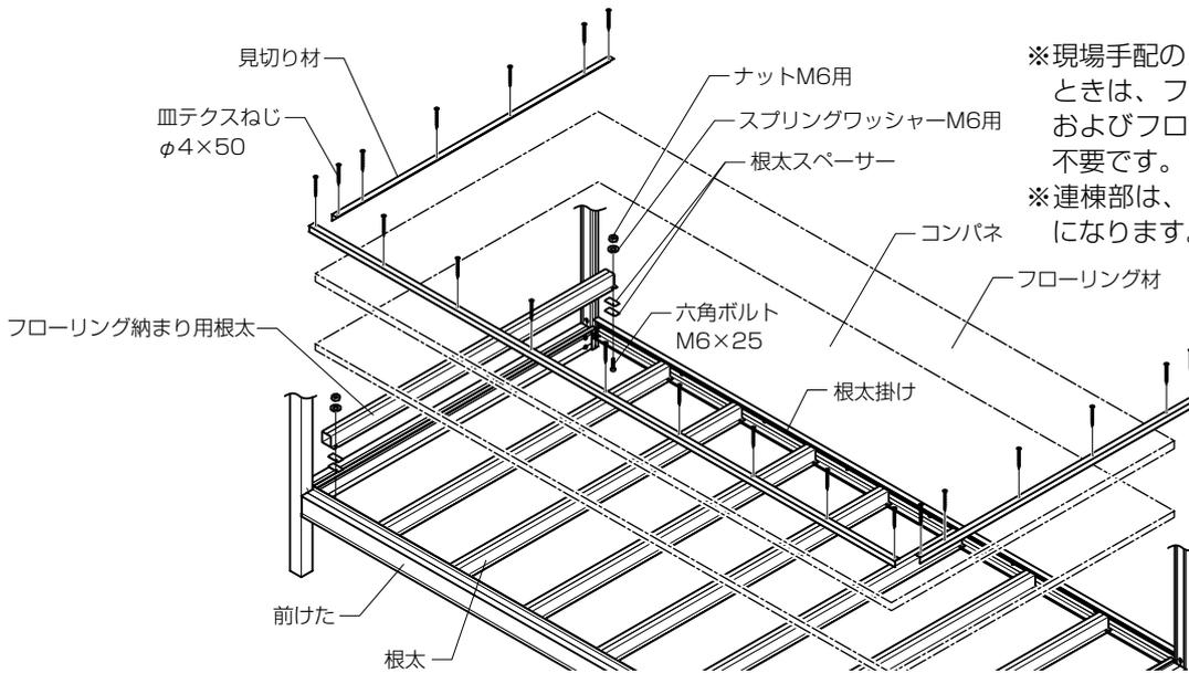
※現場手配のコンパネが厚さ18mmのときは、フローリング用スペーサーおよびフローリング納まり用根太は不要です。
