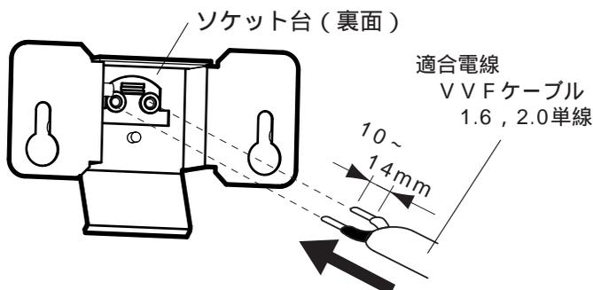
器具の取り替えなどで電源線を外す場合は、マイナスドライバーなどで解除ボタンを押しながら電源線を引き抜く
