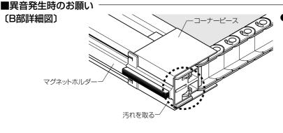
●網戸の開閉の際にスライドバー下部より異音(キーキー音)が発生する場合があります。その場合は、スライドバー下部のコーナーピース(左図)が汚れていると思われますので、網戸本体を取外し、ブラシなどで汚れを取除いてください。
