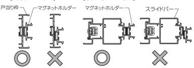
※上図のようにマグネットホルダーがずれて固定される場合は、マグネットの溝を図の通りにしてください。
