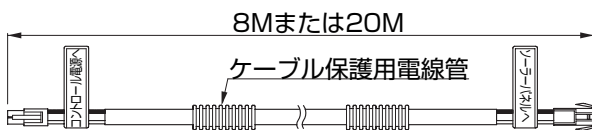
図13-1 ソーラー用電源ケーブル
