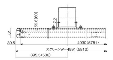
※1 本図は55サイズ 6・8本柱を示します。 60サイズは〈 〉に示します。 ※2[ ]内寸法はラッピング形材を示します。
