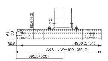
※1 本図は55サイズ 6・8本柱を示します。60サイズは〈 〉に示します。※2[ ]内寸法はラッピング形材を示します。
