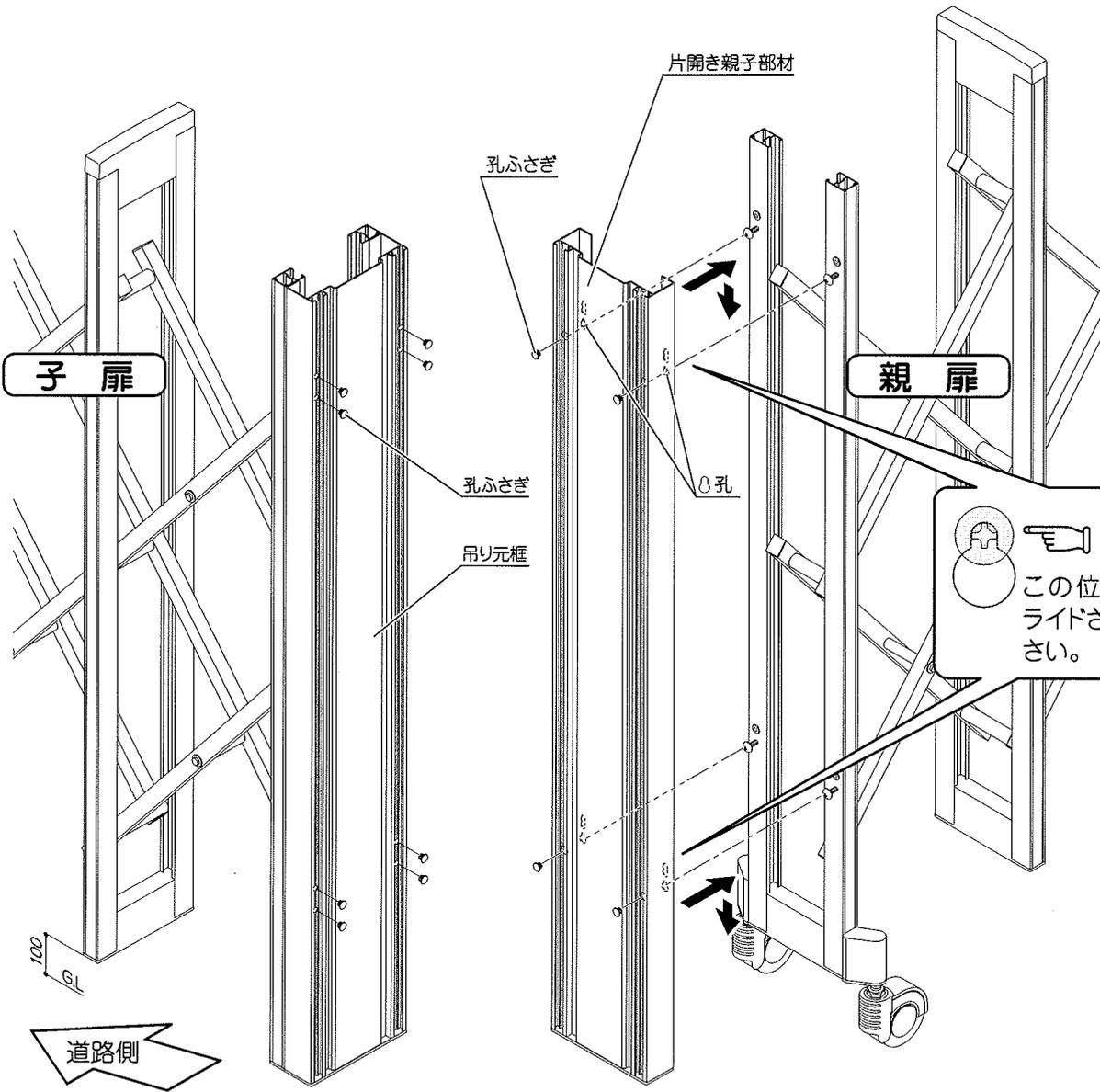
⑤ジョイント部材を親扉側、親子部材と子扉側吊り元框にスライド挿入してください。
