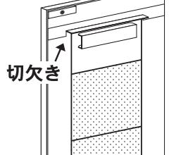
粘着シートの取り付けはカバーの切欠きに合わせる
