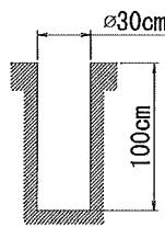
3. 穴の底に10cm以上の厚さで碎石を敷き、平坦にします。水はけと製品の沈下防止のため、必ず行って下さい。
