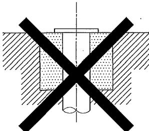
必ず基礎はセメントに粗骨材（砂利）を混ぜたコンクリートで施工してください。
