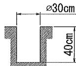
3. 穴の底に10cm以上の厚さで碎石を敷き、平坦にします。水はけと製品の沈下防止のため、必ず行って下さい。
