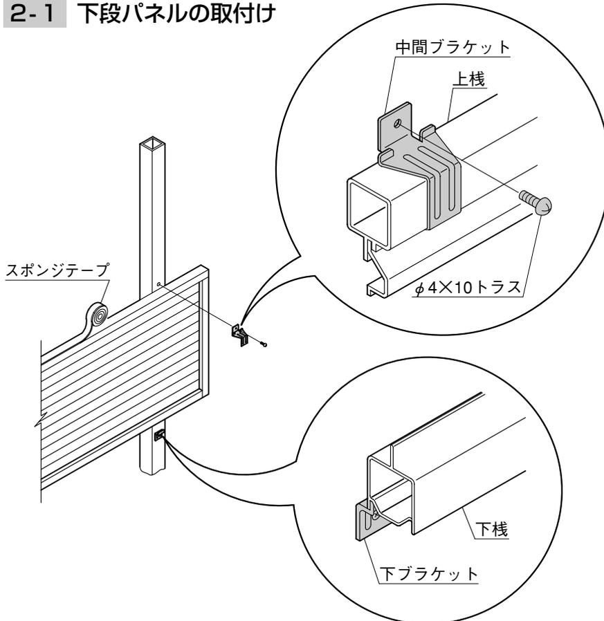
1 柱GL部に付いている下ブラケットに下棧をひっかけて上棧を中間ブラケット取付けて下さい。
