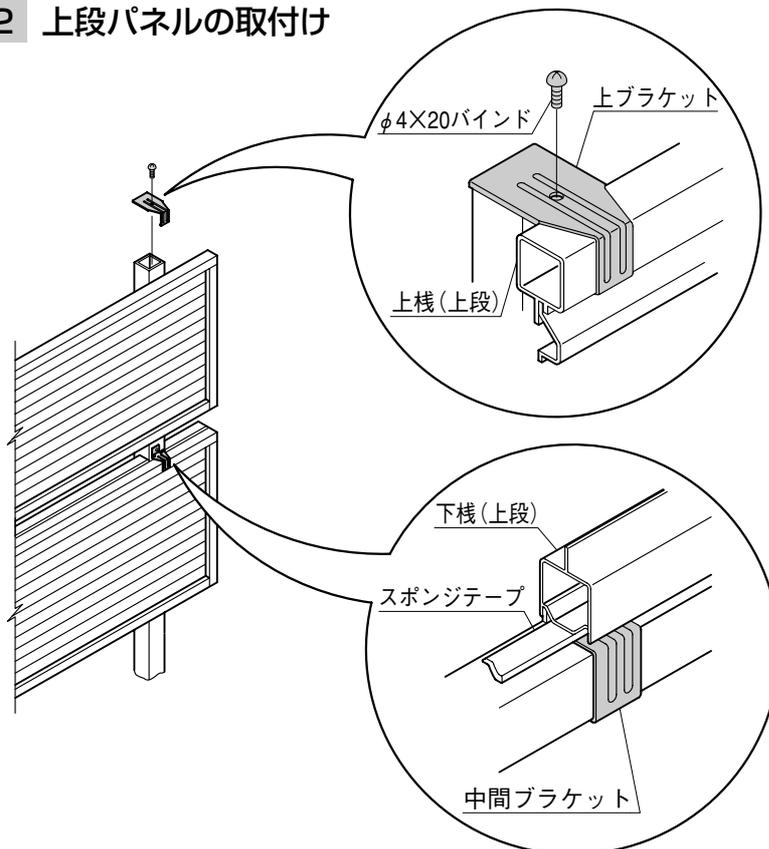
1 中間ブラケットのツメに下棧をひっかけて、上棧を上ブラケットで取付けて下さい。
