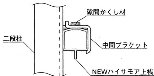
❷中間ブラケットを取付けた後に隙間かくし材を貼って下さい。
