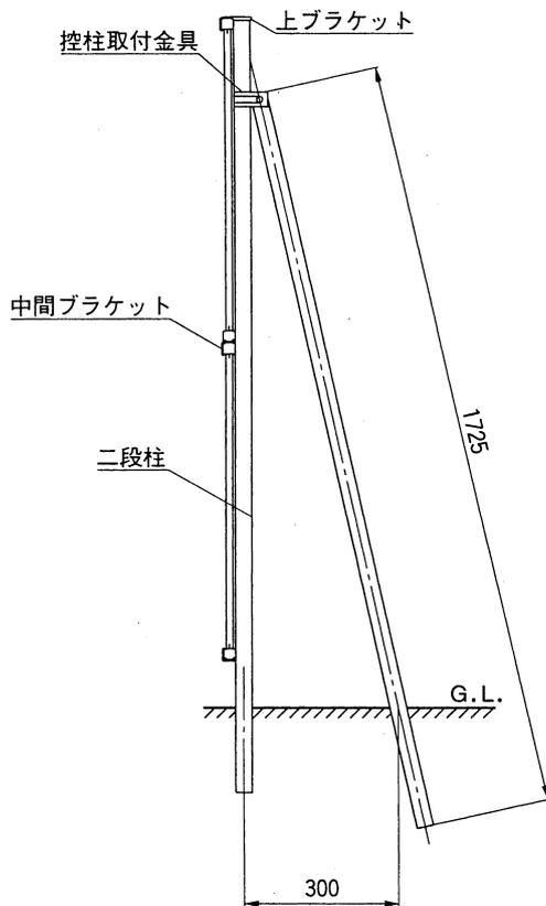
❶ 二段柱と控柱のGL面での標準距離は300mmです。
