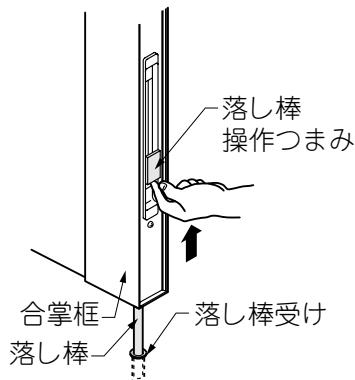
① 落し棒を上げて門扉を開くには、落し棒操作つまみを上げます。
