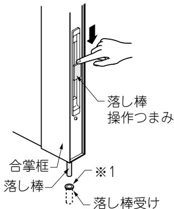
① 落し棒を下げる門扉を固定するには、落し棒操作つまみを下げます。
