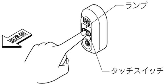
①タッチキーリモコンを携帯してタッチスイッチを押すと、ランプが点灯して解錠・施錠します。
