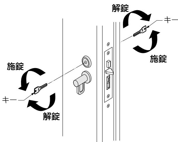
①キーで施錠・解錠するには、図にしたがって操作します。
