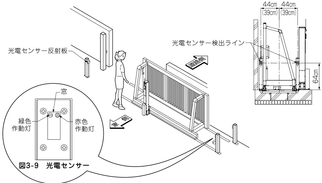
図3-9 光電センサー
