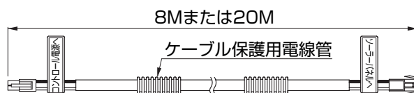
図9-1 ソーラー用電源ケーブル
