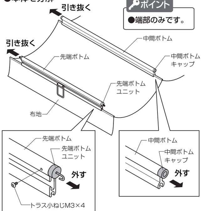
●布地、先端ボトム、中間ボトム、鉄芯の加工
