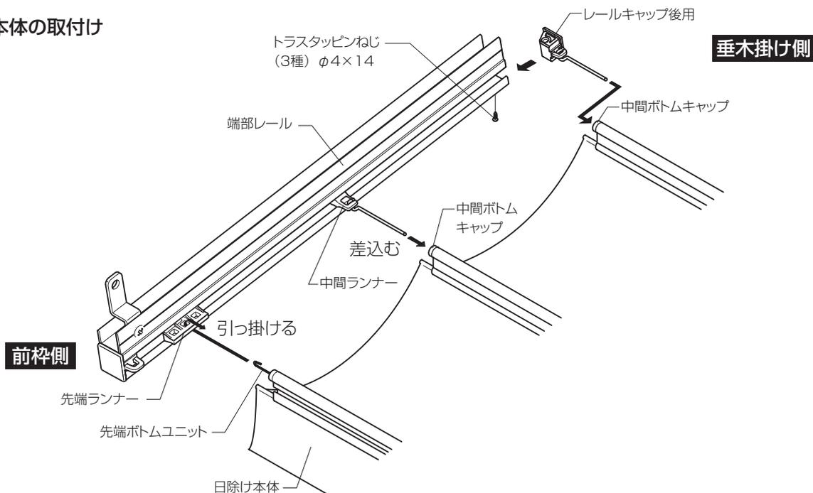
**5** フラットタイプ屋根 600タイプ 3~6尺・9尺時、1500タイプ 3~6尺時 布位置調整
