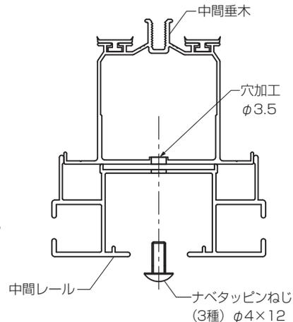
3 フラットタイプ屋根 1500タイプ 9尺時のみ 端部の加工
