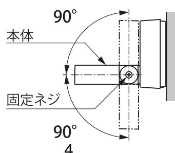
・上下方向の角度調整は固定ネジを緩めて本体を可動させ、調整後に固定ネジを締め付ける。
