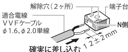
器具の取り替え等で電源線を外す場合は、マイナスドライバー等を解除穴に差し込みながら電源線を引き抜く。
