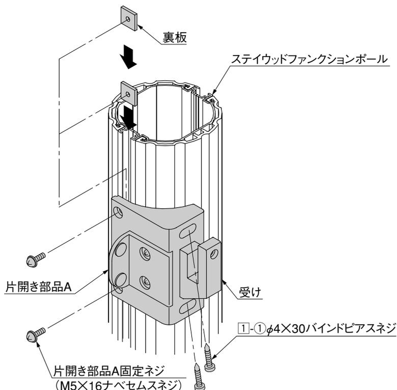
① ポールの溝に裏板を通すようにして片開き部品Aを指定の位置に固定してください。
