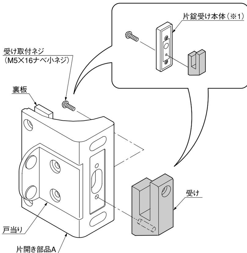
① 片錠受け本体の「受け取付ネジ」を取外し、受けと「受け取付ネジ」を取出して下さい。
