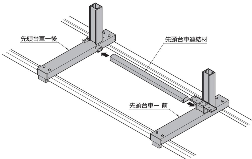
①先頭台車一前・後に取付けてある先頭台車連結材スリーブに先頭台車連結材を差込んでください。
