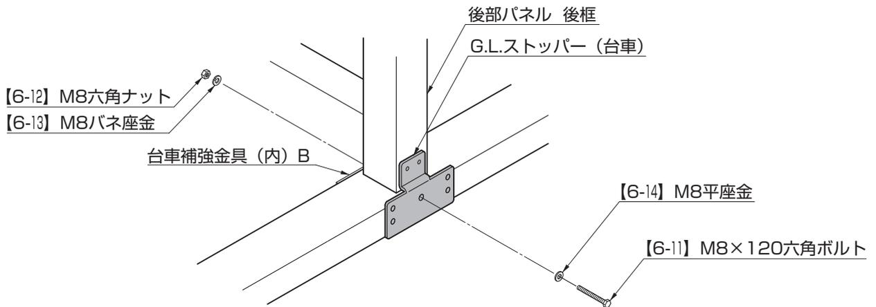
①G.L.ストッパー（台車）と台車補強金具（内）Bをはさむように、【6-11】、【6-14】、【6-13】と【6-12】を取付けてください。
