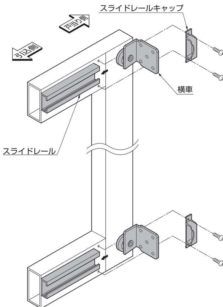
①本体パネル戸当り側のスライドレールキャップのネジをはずし、横車をスライドレールに挿入し、再びスライドレールキャップを取付けてください。
