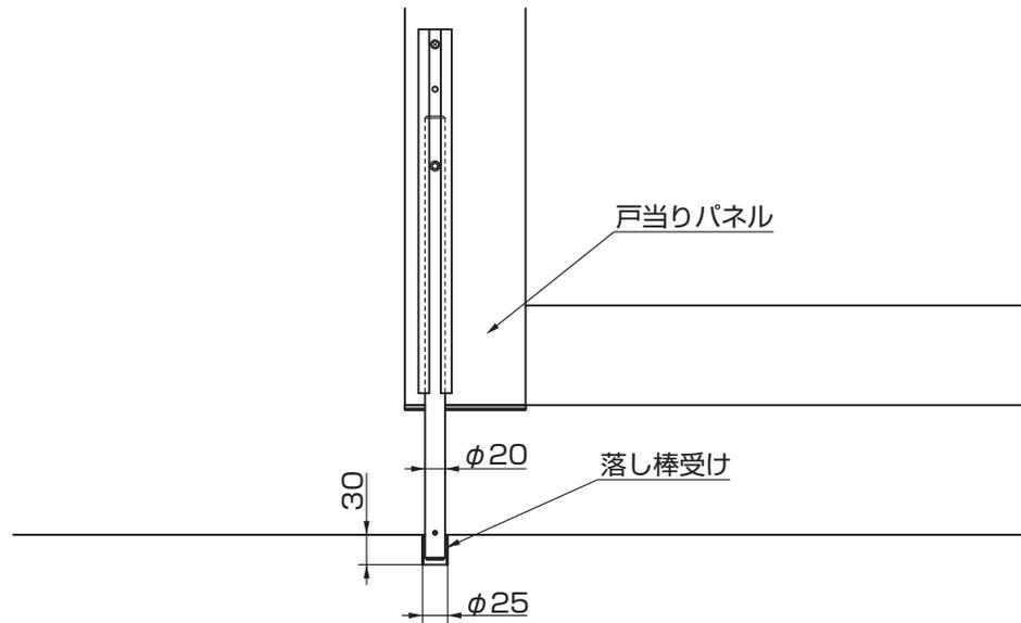
① 落とし棒受けは、引き戸を閉めた状態と開けた状態で、落とし棒が落とし棒受けに入る位置に各々埋込んでください。
