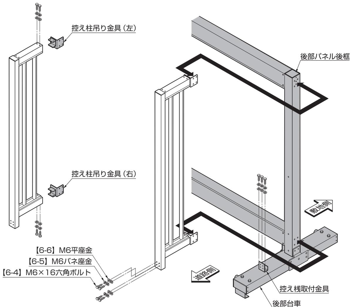
①図のように、控え柱に控え柱吊り金具を【6-4】、【6-5】、【6-6】で取付けてください。
