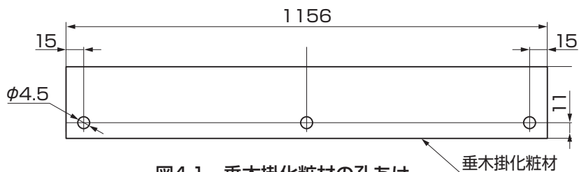
図4-1 垂木掛化粧材の孔あけ
