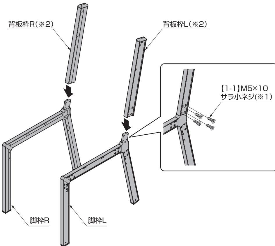
① 脚枠と背板枠を【1-1】で取付けてください。
