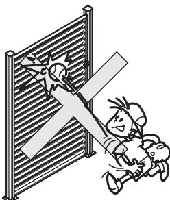
●ルーバーパネルにボールをぶつけるなど強い衝撃を加えないでください。部材が変型・破損したり、ケガをするおそれがあります。
