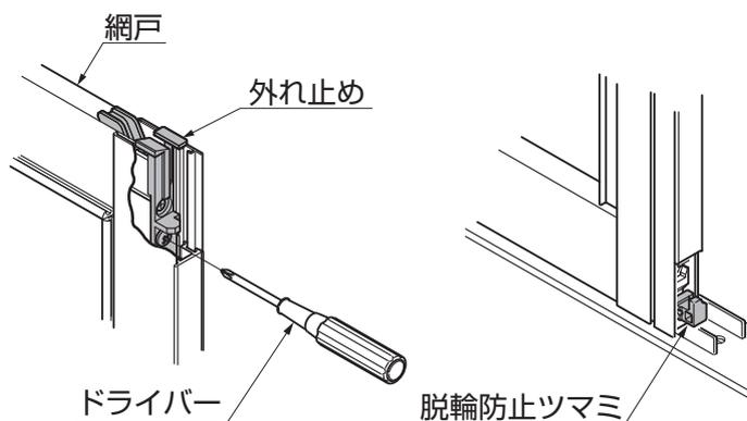
① 網戸上部に付いている外れ止めと、網戸下部に付いている脱輪防止ツマミを解除します。
