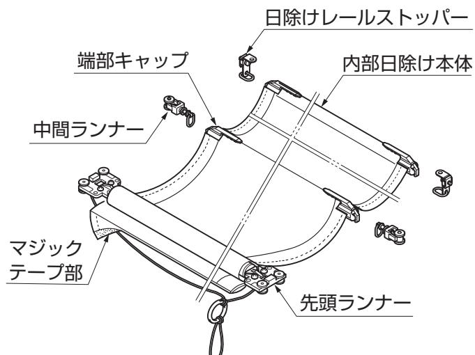
①後側のランナーから、内部日除け本体の端部キャップをはずします。
