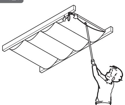
● 内部日除けの操作前には、リングが固定金具から外れているか確認してください。固定金具からリングが外れていないで操作すると固定金具が破損して落下するおそれがあります。
