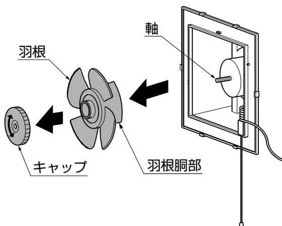
③羽根が回転しないように羽根胴部を押えながらキャップを「ユルム」の方向に回してキャップを外します。
