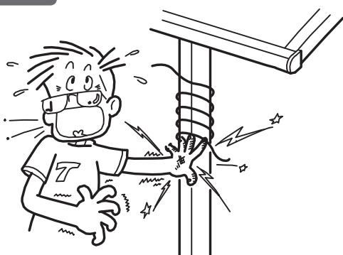
●製品に電線を巻き付けないでください。漏電により、感電するおそれがあります。
