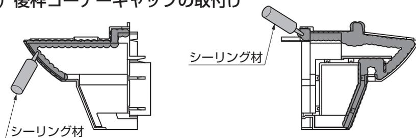
図10-6 後枠コーナーキャップのシーリング箇所
