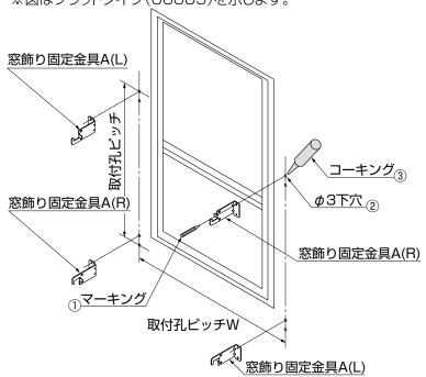
①窓飾り固定金具A(R)、窓飾り固定金具A(L)の 取付け位置の穴位置にマーキングしてください。
