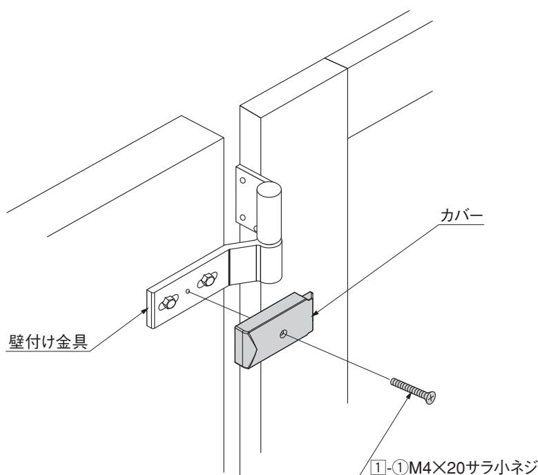
① 壁付け金具にカバーを[1]-①で取付けてください。
