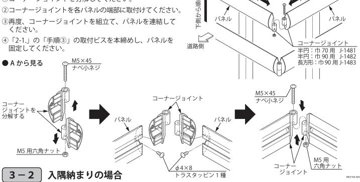
①図を参照して、コーナージョイントで「下側」から順にパネルを連結してください。
