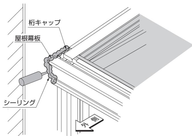
●中間柱の場合、連棟の場合 柱と妻梁・桁室内側カバー継ぎ目のシーリング 特殊納まり
