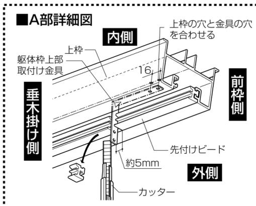
図-1 前枠側枠取付け金具の取付け位置
