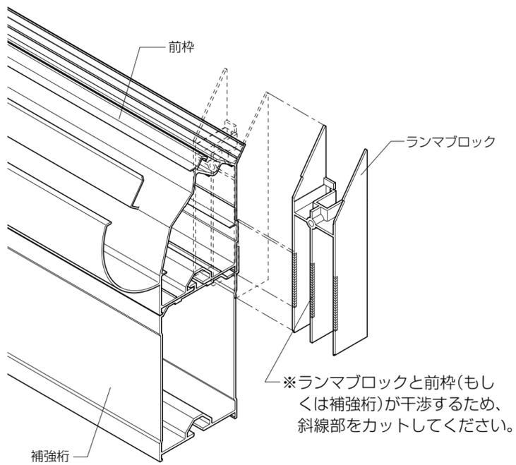
図-4 前枠端部キャップの加工(アルファテラスに取付ける場合)
