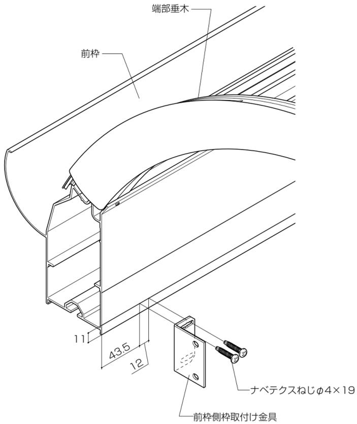
図-2 前枠側枠取付け金具の取付け位置
