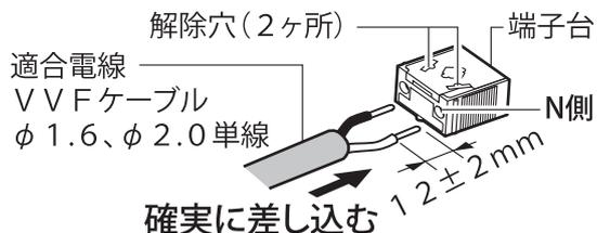
器具の取り替え等で電源線を外す場合は、マイナスドライバー等を解除穴に差し込みながら電源線を引き抜く。
