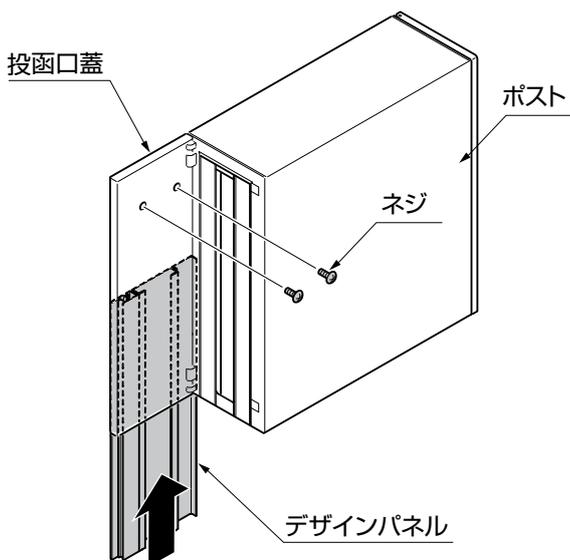
①デザインパネルを投函口蓋にスライドして背面側のネジを取付けてください。
