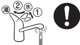
水栓柱上部の左側は給湯側のため高温になる場合があります。水栓柱の金属部に直接手や肌を触れないようにしてください。
