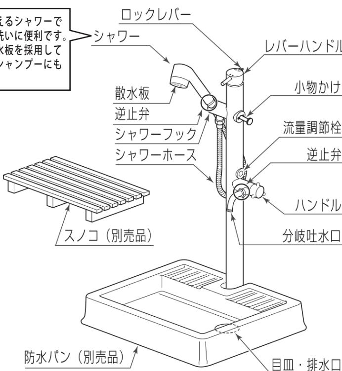
シャワーの温度調節・流量調節・吐水・止水が片手でできるシングルレバー方式で作業が楽になります。
