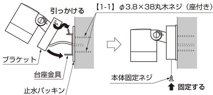
④結線したケーブルを収納しながらブラケット内の金具を台座金具に引っ掛け、止水パッキンに押し当ててください。
