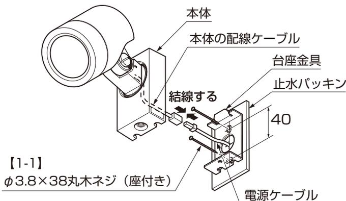
② 電源ケーブルを止水パッキン・台座金具の孔から引き出し、壁面に台座金具および止水パッキンを【1-1】で取付けてください。
