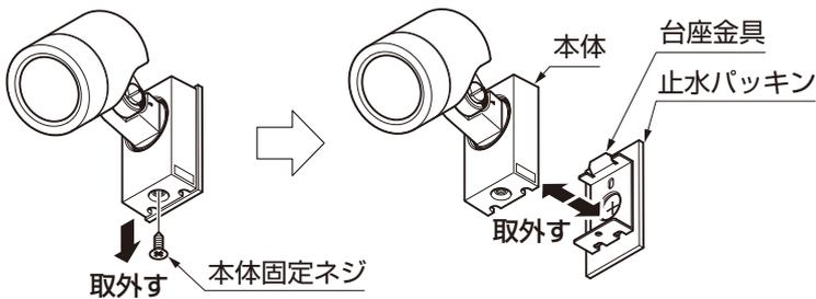
① 本体固定ネジを外し、台座金具および止水パッキンを本体から取外してください。
