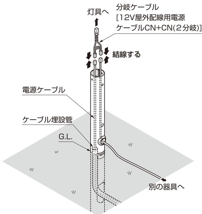
※ポールの埋込みが完了した後
