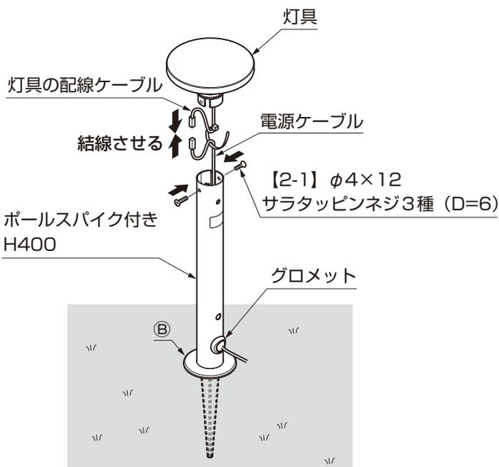
はじめに、グロメットを取外して孔をあけて、再度取付け、ポール上端からグロメットにかけて針金を通してください。
