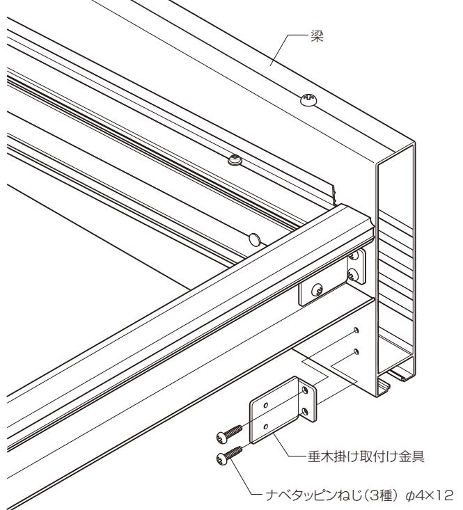
②軒天枠（軀体側）、軒天枠（連結側）を垂木掛け取付け金具に取付けて下さい。
