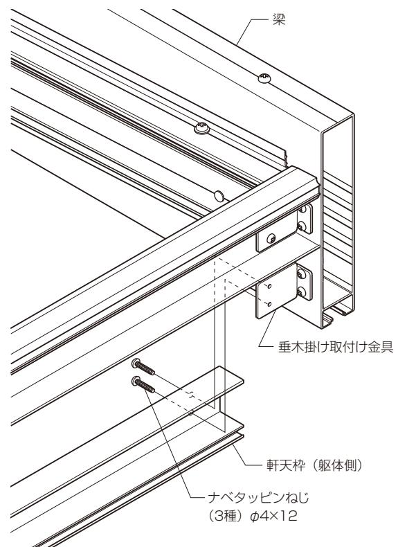
③軒天枠（前枠側）を前枠に合わせて固定します。
