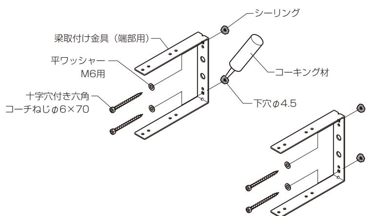
②機能ユニット・柱側に梁受け金具（端部用）を取付けてください。
