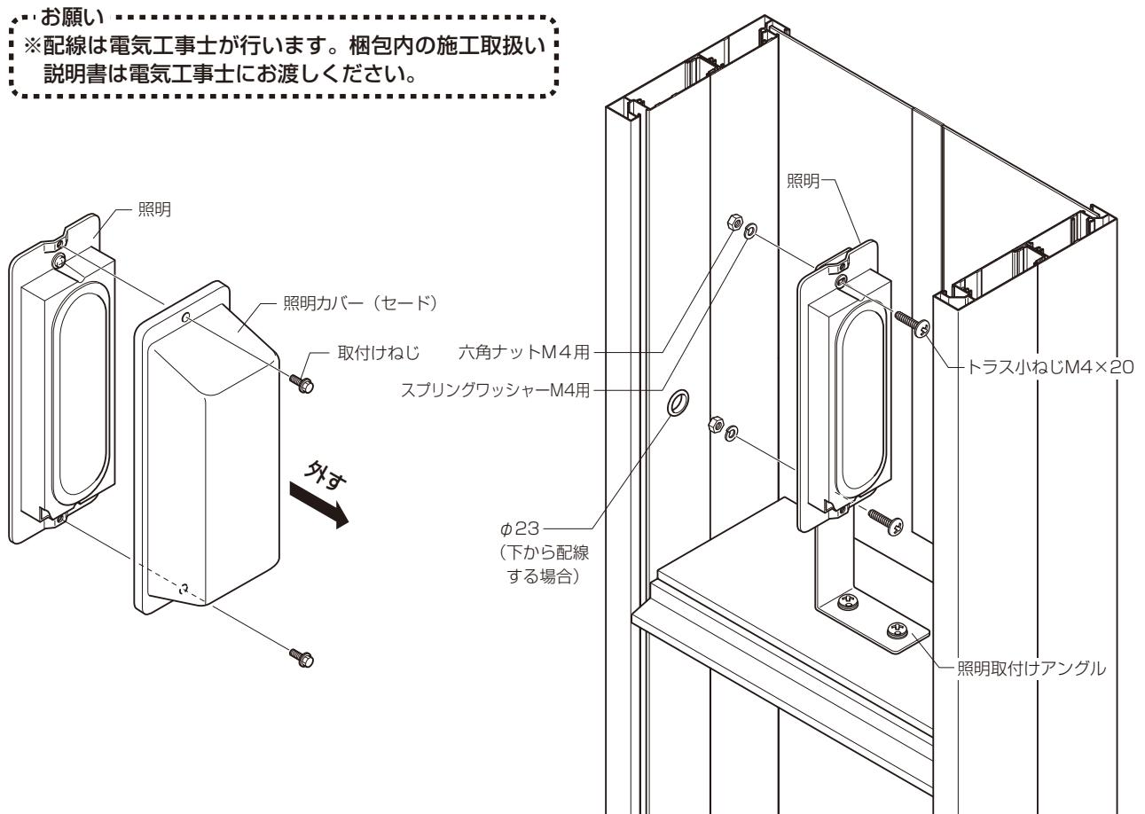
⑥照明カバー（セード）を取付けてから点検パネルを取付けてください。
