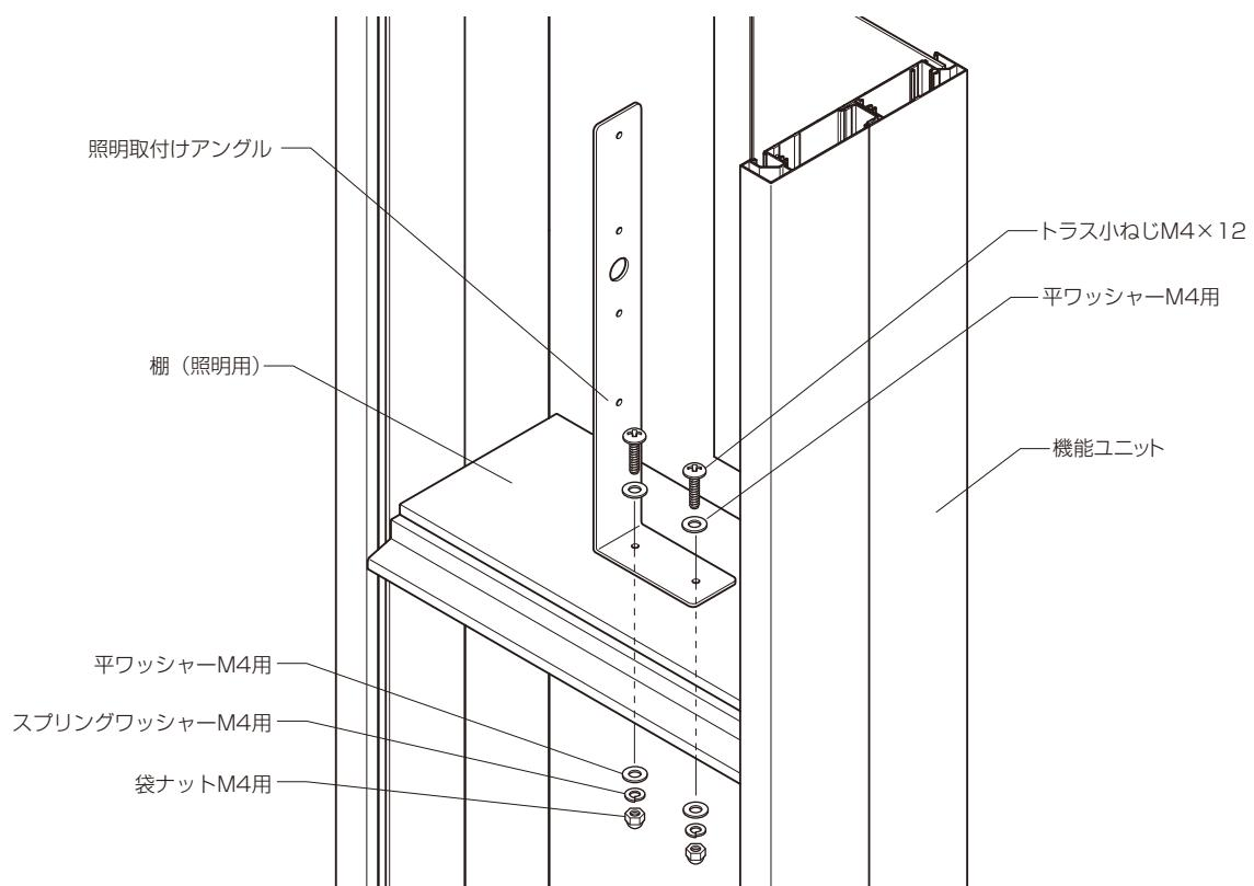
⑤照明のカバー（セード）を外して、照明取付けアングルに照明を取付けてください。
