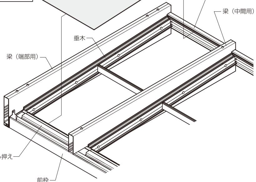
③屋根材カバーを垂木掛け側から押込み、ねじ止めしてください。
