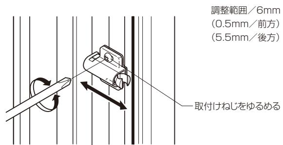
※調整後、取付けねじを必ず締め直してください。
