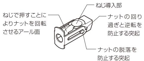
●ターンナットを下穴に挿入し、軽く押込みながら締付けてください。
