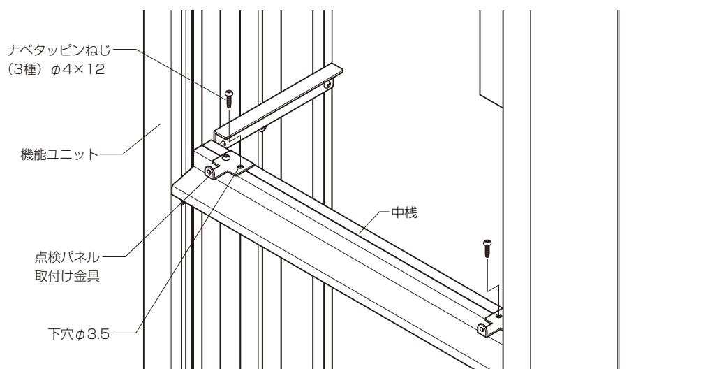
④棚（照明用）に照明取付けアングルを取付けてください。
