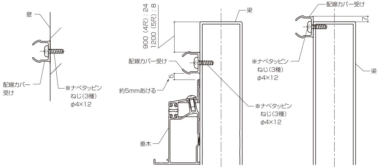
③躯体への取付けは、電源線の位置と配線カバー受け端部を結んだ位置に固定してください。
