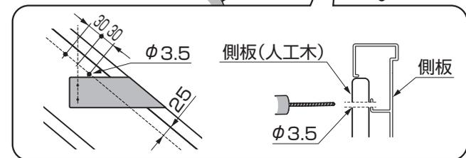
② グリップライン取付金具取付穴の上側に  $\phi 3.5$  の穴を2つあけてください。(図3-2参照)
