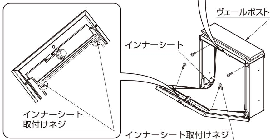
②インナーシート取付けネジを4点外し、インナーシートを外してください。
