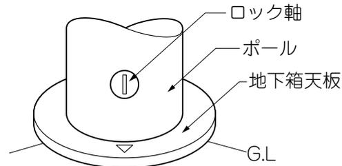
ポールを出すときには地下箱天板の▼印とキー差し込み穴を必ず合わせてください。合っていない場合わずかな衝撃でポールが落下しケガをするおそれがあります。
